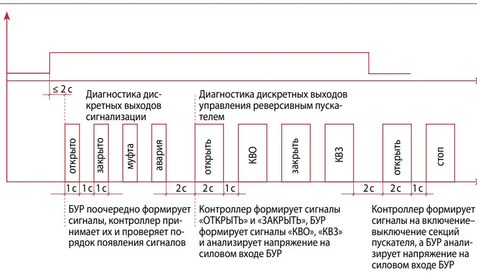
Рис. 2. Диагностика цепей управления и сигнализации
